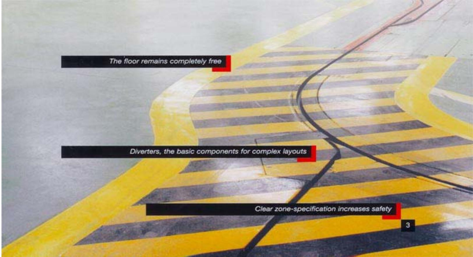
Kod podnih konvejera **element koji nosi teret je u obliku platforme sa kolicima**, koje se pomoću vučnog elementa premeštaju duž transportne trase. Dele se na:
