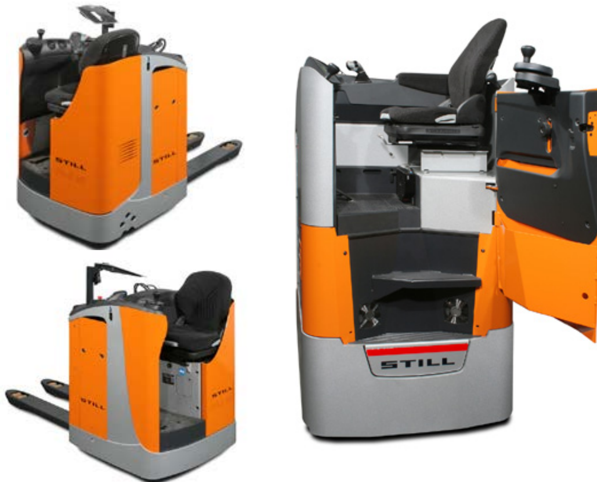
Слика 2.2: Ручни електрични виљушкар за утовар/истовар, са платформом за руковаоца
