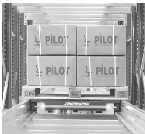
Слика 13-74. Складиште Jungheinrich са "шатл" технологијом
