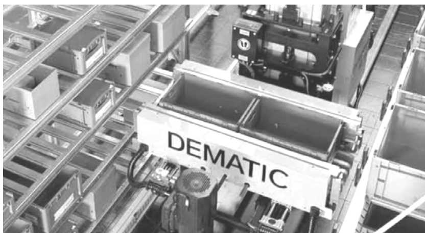
Слика 13-79. Носач касета на лифту аутоматске дизалице
