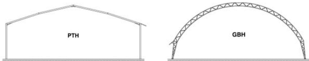
Слика 9-11. Монтажне хале (Agrotel GmbH): Хала "I - профил" конструкција ( L = 10 - 22 \text{ m} ) и решеткаста тунел конструкција ( L = 15 - 25 \text{ m} )
